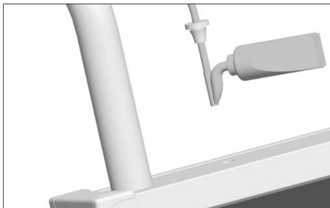
Infilare il sensore di temperatura nel manicotto a immersione fino all'arresto. Chiudere ermeticamente l'alloggiamento del collettore con il tappo, verificandone il corretto posizionamento.
