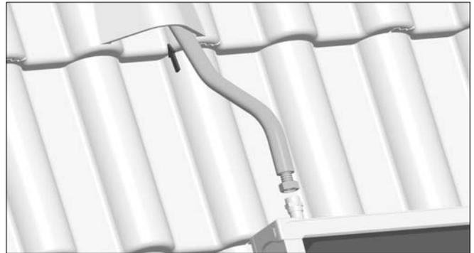
20. Montare il tubo ondulato (15) con le guarnizioni sui raccordi esterni dei collettori. Prestare attenzione al corretto alloggiamento delle guarnizioni. Infilare il tubo isolante, precedentemente arretrato, nel raccordo fino all'alloggiamento del collettore.
