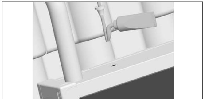
25. Infilare il sensore di temperatura nel manicotto a immersione fino all'arresto. Chiudere ermeticamente l'alloggiamento del collettore con il tappo, verificandone il corretto posizionamento.
