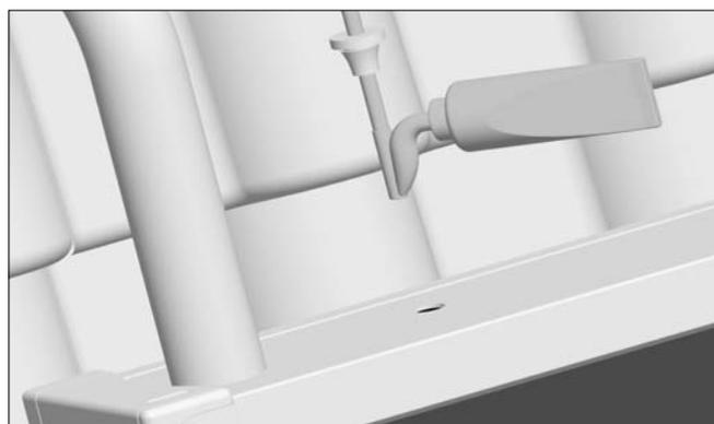
Infilare il sensore di temperatura nel manicotto a immersione fino all'arresto. Chiudere ermeticamente l'alloggiamento del collettore con il tappo, verificandone il corretto posizionamento.
