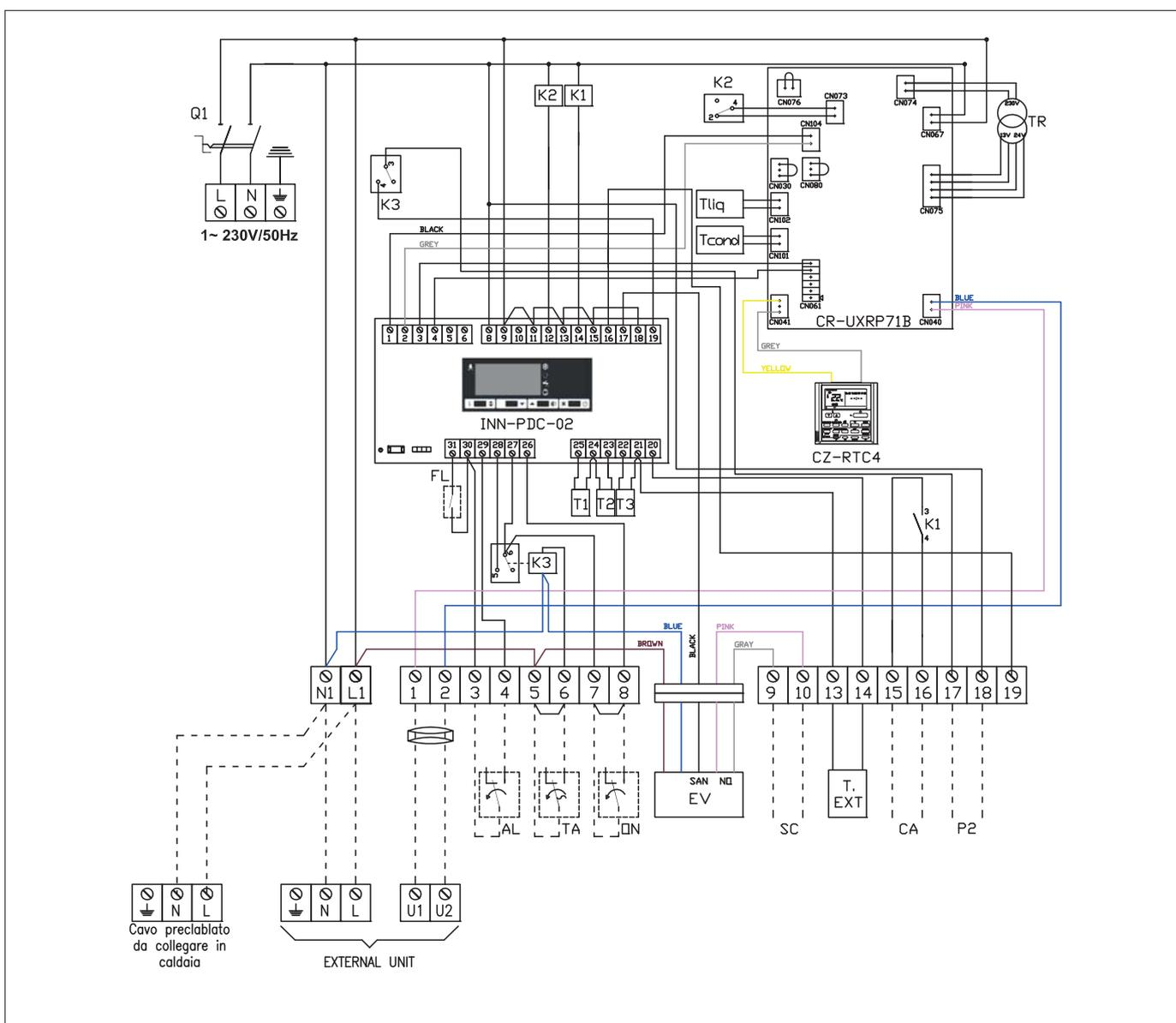
2.6 Schema elettrico caldaia ModuStar
