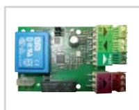
Permette di gestire l'abilitazione ad un generatore di calore integrativo (caldaia o pompa di calore) in funzione della sonda T5 da posizionare sul collettore di mandata.
