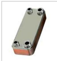
Scambiatore di calore a piastre saldobrasato in acciaio inox AISI 316L, privo di guarnizioni. Pressione di esercizio max 30 bar. Attacchi filettati maschio da 1". Garantisce un ridottissimo salto termico tra circuito primario e circuito secondario, permettendo così di ottenere il massimo rendimento dal cogeneratore.
