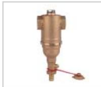
Separatore di impurità e fanghi, caratterizzato da perdita di carico estremamente ridotta ed elevata capacità di filtrazione. Installabile sia in orizzontale sia in verticale. Pressione max d'esercizio: 3 bar. Attacchi filetto femmina da 1" per il DN 25 e da 1" 1/4 per il DN 32.
