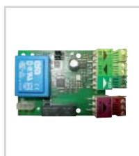
Permette di interfacciarsi con un contatore dell'energia elettrica assorbita dall'utenza, per ottimizzare la modulazione della potenza al fine di massimizzare l'autoconsumo dell'energia prodotta in cogenerazione (minima cessione in rete).
