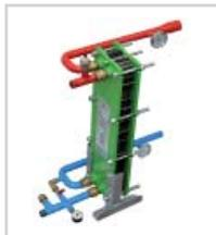
Scambiatore di calore a piastre ispezionabili in acciaio inox AISI 316L sp. 0,4 mm, guarnizioni in EDPM. Pressione di esercizio max 10 bar. Telaio in acciaio al carbonio con attacchi filettati femmina da 1". Garantisce un ridottissimo salto termico tra circuito primario e circuito secondario, permettendo così di ottenere il massimo rendimento dal cogeneratore.
