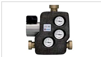
Gruppo pompa in classe A da impiegare per il circuito caldaia a legna - accumulo. Necessario per prevenire la formazione di condensa dovuta a temperature di ritorno troppo basse. Composto da pompa di circolazione e valvola miscelatrice termostatica. Collegamenti da 1"1/2. Isolamento in EPP e termometri inclusi.
