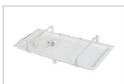
Kit bacinella riscaldata per raccogliere la condensa dell'unità est. della pompa di calore. Completo di resistenza e cavo. Misure (LxPxH): mm 945x425x25 (per maggiori informazioni vedere il THIT9278).
