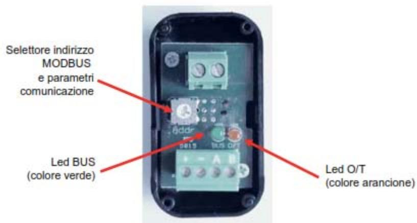
Modulo OT per caldaia singola
