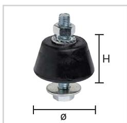
N.4 piedini antivibranti per l'unità esterna della pompa di calore. Realizzati in gomma naturale vulcanizzata con inserti metallici filettati, permettono di isolare ed in molti casi eliminare del tutto le vibrazioni prodotte dalle macchine" carico massimo 50 kg. Misure (ØxH): mm 40x20
