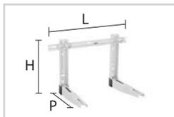
Kit staffa per la bacinella raccogli-condensa dell'unità est. della pompa di calore.
