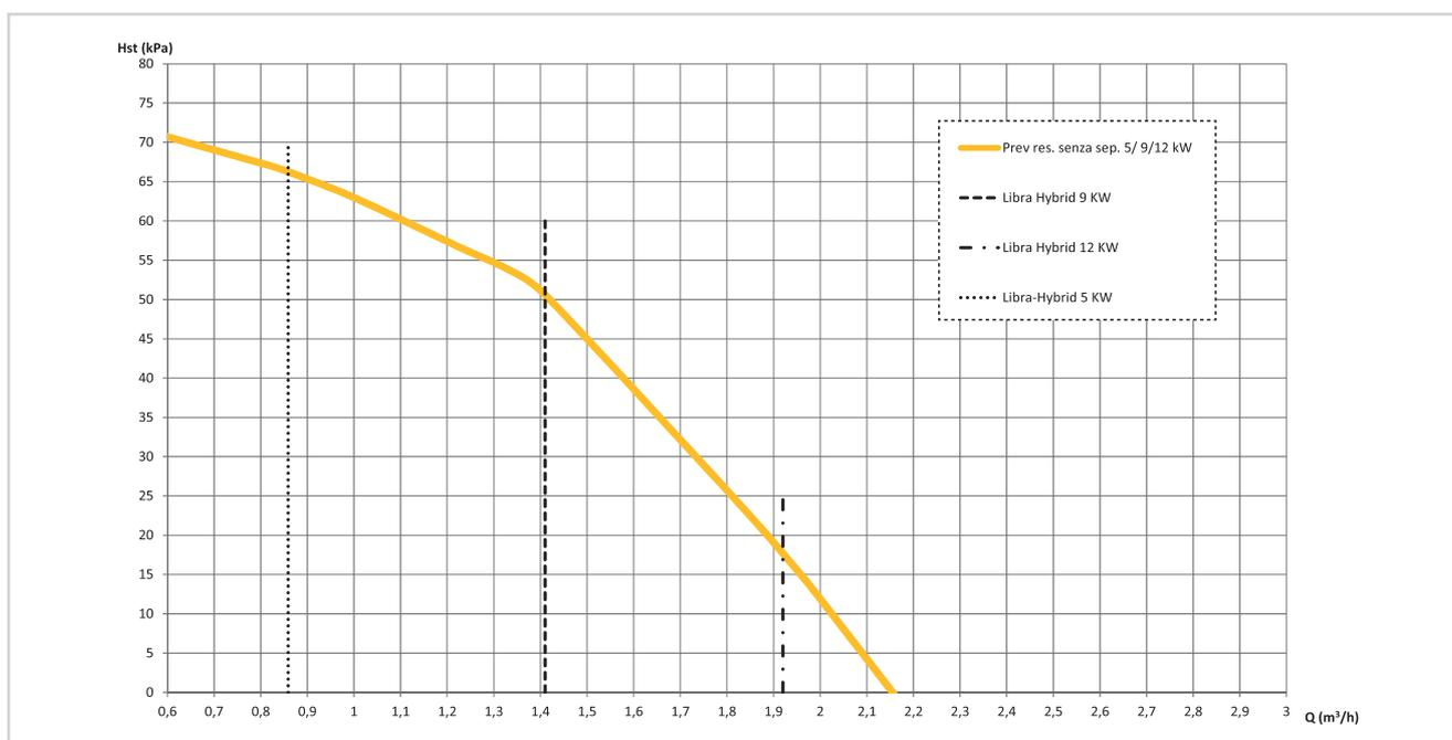
Nota: non sono tenute in considerazione le resistenze del filtro a rete (Kv 11) x 1" - (Kv 18) x 1"1/4.
