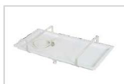
Kit bacinella riscaldata per raccogliere la condensa dell'unità est. della pompa di calore. Completo di resistenza e cavo. Misure (LxPxH): mm 945x425x25.
