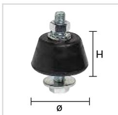
N.4 piedini antivibranti per l'unità esterna della pompa di calore. Realizzati in gomma naturale vulcanizzata con inserti metallici filettati, permettono di isolare ed in molti casi eliminare del tutto le vibrazioni prodotte dalle macchine" carico massimo 50 kg. Misure (ØxH): mm 40x20
