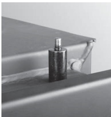
Montare 2 fissaggi per condotto gas
