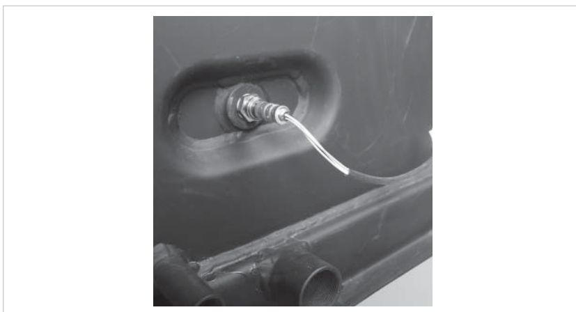
Sonda Lambda montata
