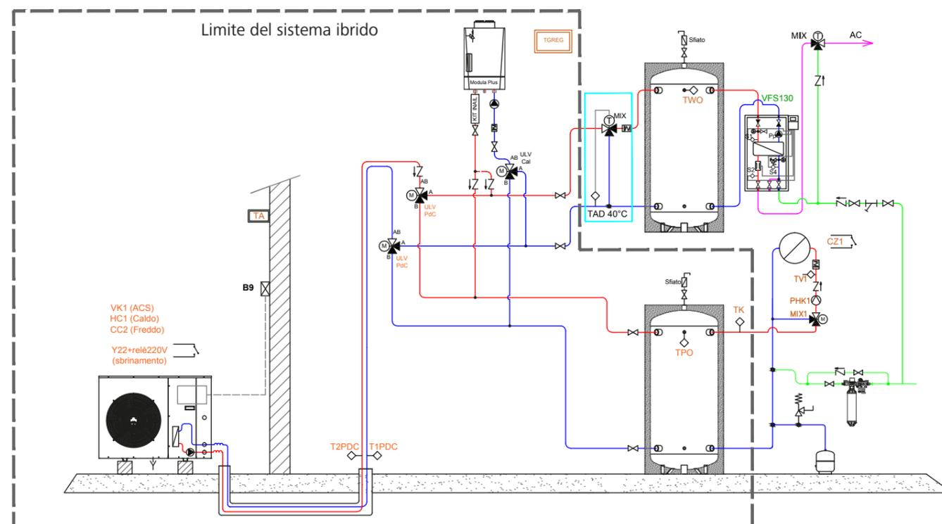
\*Schemi di impianto adatti per impianti con ModuExpo HT 09-24
